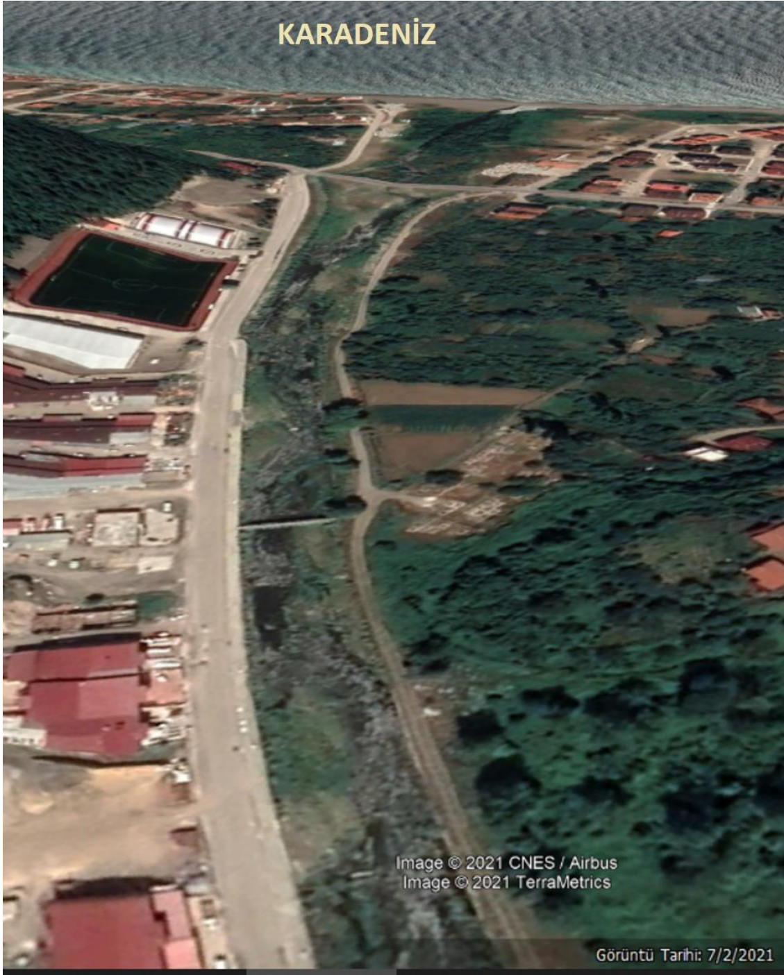
Şekil 8. DSİ tarafından ıslah edilen Ezine Çayı yatağının denize çıkış ağı kesitini daraltan sediment birikimi ve bitki gelişimi. Görüntü Tarihi: 7 Şubat 2021
